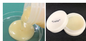
イヨカン内皮 CNF とスクワランオイルの乳化試料（写真左）、それを 10% 配合したハンドジェル（同右）
