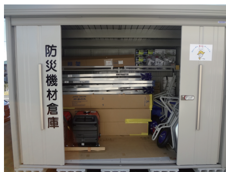
防災機材倉庫、メガホン、二つ折り担架、折り畳み梯子、LEDライト、一輪車、発電機、テントなど
