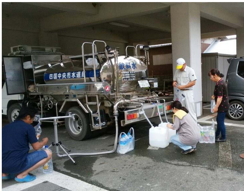
給水車や応急給水装置の使用例
