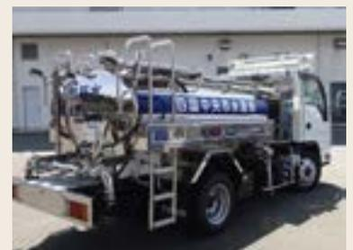
今回整備した加圧式給水車。災害や漏水時には、高所にある受水槽に給水したり、短時間かつ効率的にポリタンクに給水したりできる。容量は2000ℓ。
