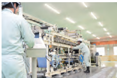
抄紙技術を用いた連続脱水シート化装置 (川之江造機株式会社との共同開発)
