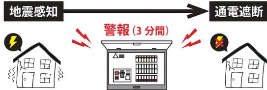
※地震感知後3分以内に停電が発生した場合は、停電復旧直後に自動で遮断します
