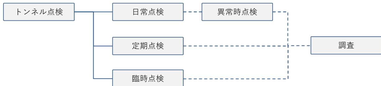
図 3.1 トンネル点検の種類
