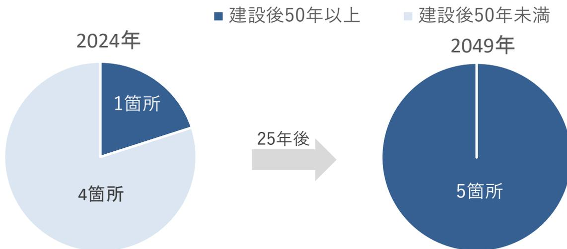
図 2.2 建設後 50 年を経過したトンネルの推移
