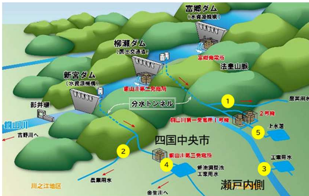
図 7-4 落差を有する銅山川からの水路
