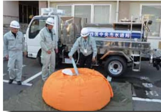
市水道局は、災害時や断水時の応急給水に対応するため約900万円をかけて、加圧式小型給水車を導入しました。この車両は、1700リットルの給水タンクを積載し、ポンプ動力で25mの高さまで給水（揚水）できる加圧式となっています。災害時には約600人が必要とする1日分の飲料水を運ぶことができます。
