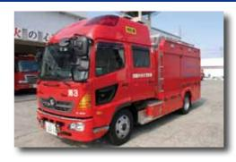
市消防本部本署に災害対応特殊水槽付消防ポンプ自 動車2型を配備しました。この車両は、水槽(2,000 リットル)を積載して迅速に放水作業を行うことがで き、圧縮空気泡消火装置を装備し、消火効率を向上す ることができます。また、大規模災害や広域災害に対 応する緊急消防援助隊登録車両となっています。
