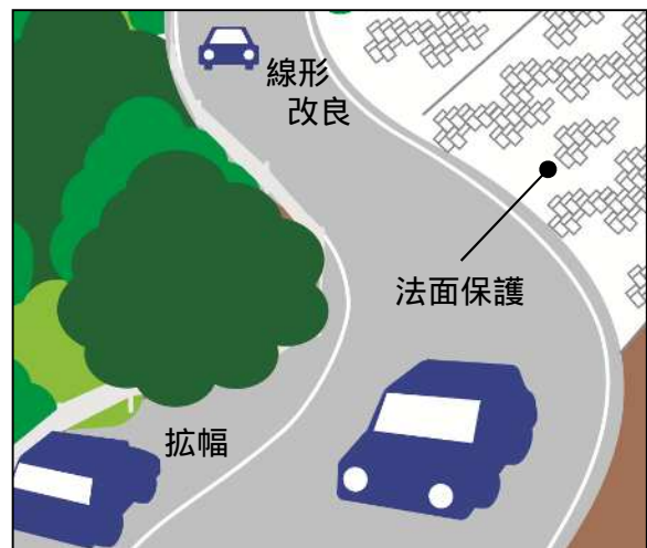
幅員狭小区間の拡幅や落石危険箇所での法面保護により道路利用者の安全性を確保
