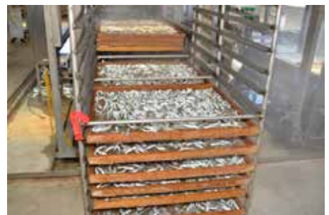
⑥自動で台車にセットされ、このまま乾燥室に搬入し、乾燥を行います
