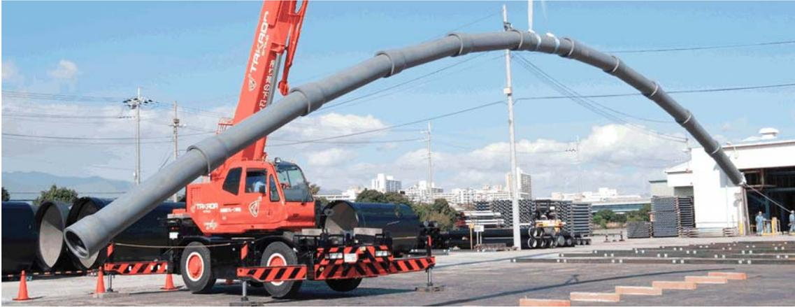
**耐震継手型ダクタイル鋳鉄管の性能イメージ**
