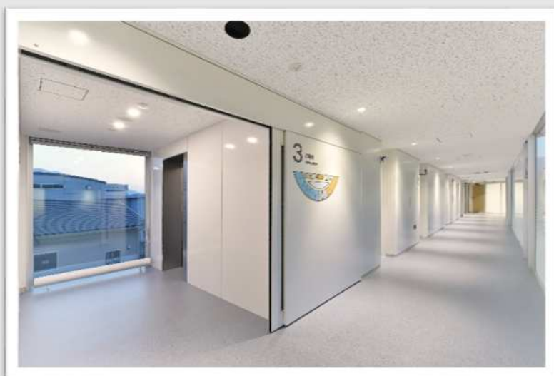
安全対策のため前室を設けたエレベーター
