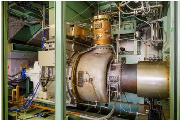
本研究開発に用いたIHI製2,000kW級ガスタービン「IM270」
